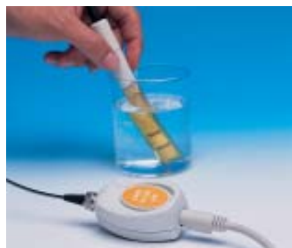
Cambios en la conductividad del agua al agregar sal
