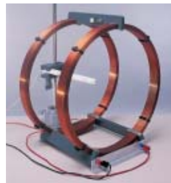
Campo magnético producido por un par de bobinas Helmholtz
