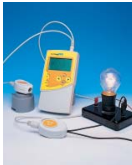
Controlando nivel de luz con un interruptor de control y un sensor de luz. Cuando el nivel de luz cae debajo de un nivel preestablecido, el DT110 enciende la luz.
