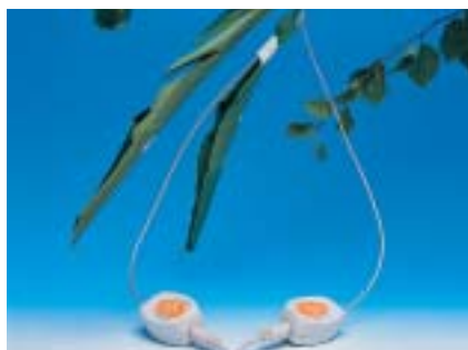
Monitoreo de la temperatura y la luz sobre y debajo de una hoja
