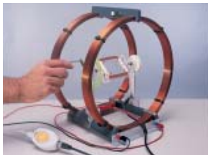
Inducción magnética en una bobina rotante en un campo magnético uniforme
