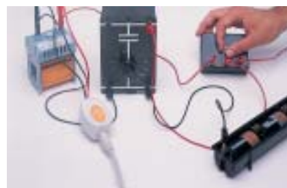
Medición de oscilaciones eléctricas utilizando el DT002
