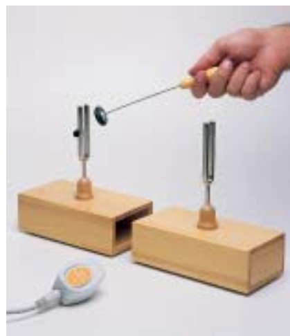
Medición de sonido de dos ondas que interfieren usando el DT008
