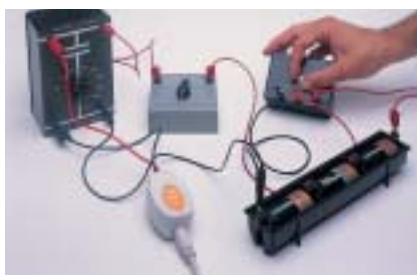
Medición de voltaje de la descarga de un condensador utilizando el DT003
