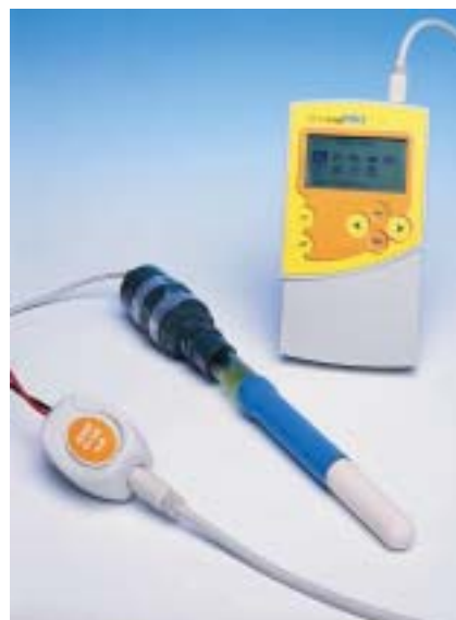
Usando el DT007 para conectar un sensor de presión industrial al MultiLogPRO.
