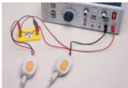
Midiendo las características de una lamparilla usando el DT006
