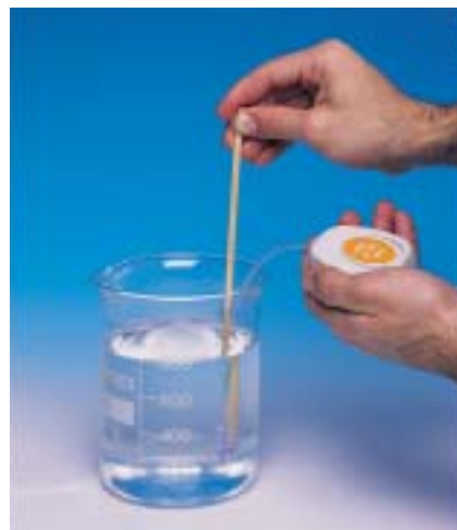
Midiendo presión hidrostática dentro del agua
