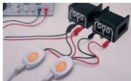
Inducción magnética en un transformador. A la bobina primaria se aplica una señal triangular
