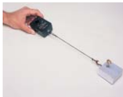
Cambio de fricción estática a dinámica
